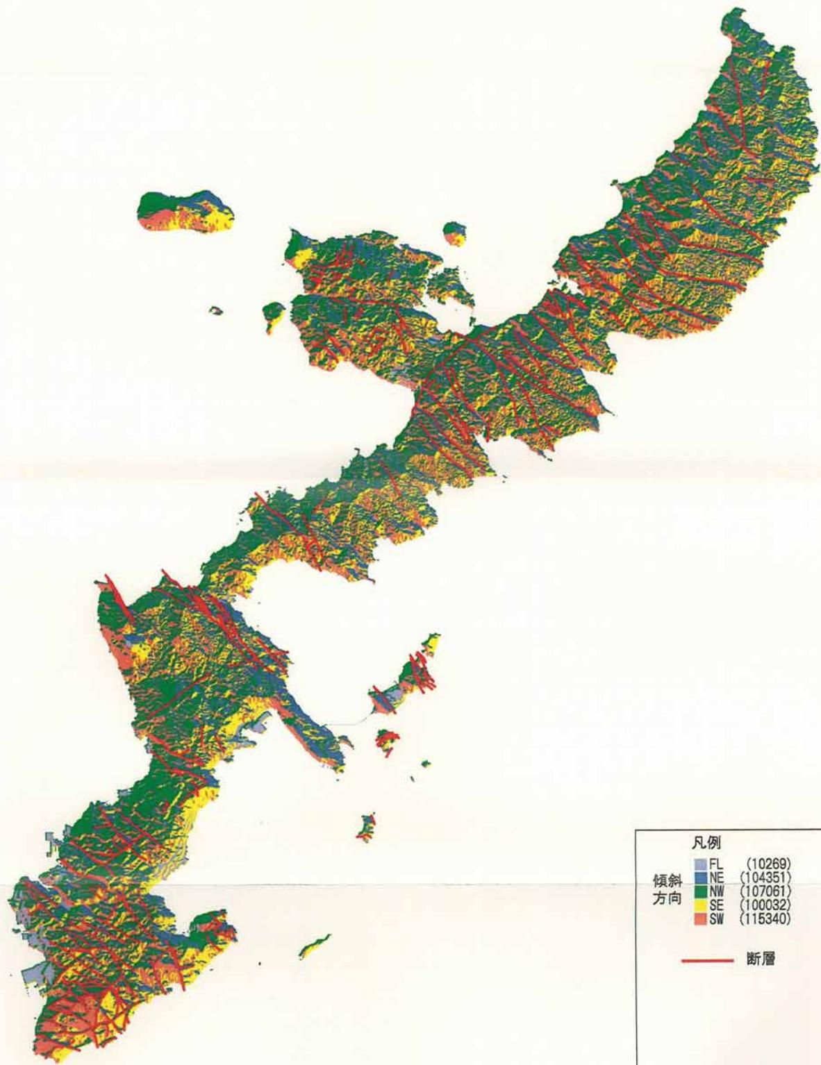
図2-9 傾斜方向分布・断層分布図
